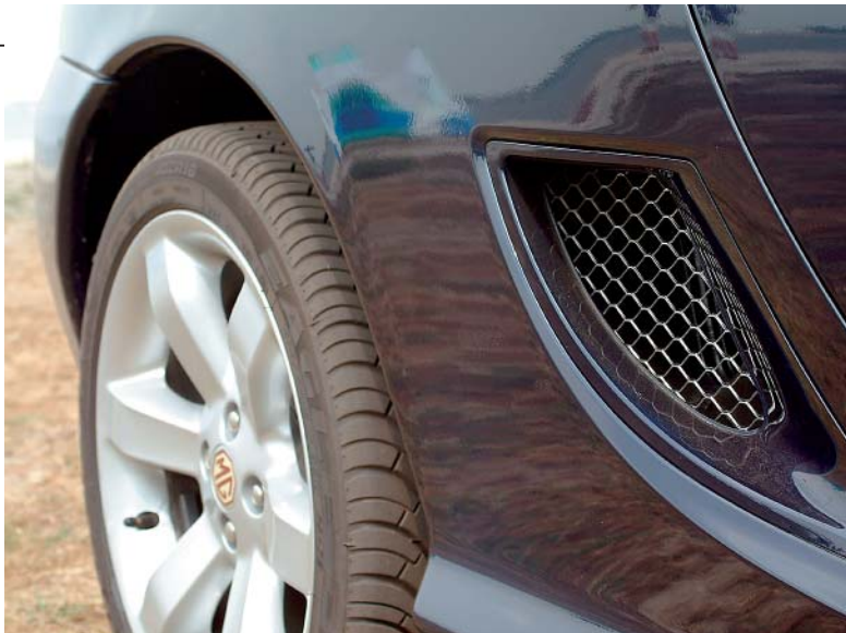
De motor van de TF ligt achter de stoelen, vandaar deze beademing in de zijkant.
