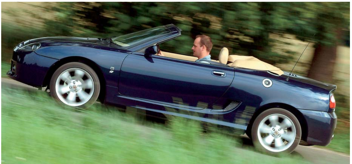
De motor van de TF ligt achter de stoelen, vandaar deze beademing in de zijkant.
